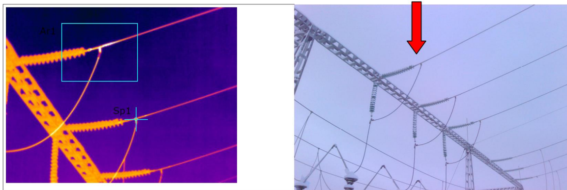
Figur 28 och 29: Till vänster visas varmgång detekterad med värmekamera, till höger visas samma område med vanlig kamera (J-O Persson, 2011).
