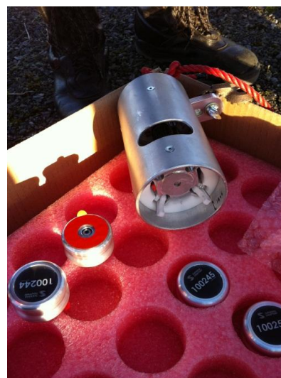
Figur 26 och 27: Till vänster montering av temperatursensor med isolerstångsmetoden, till höger temperatursensor och specialtillverkat verktyg (Egen bild, 2011)
